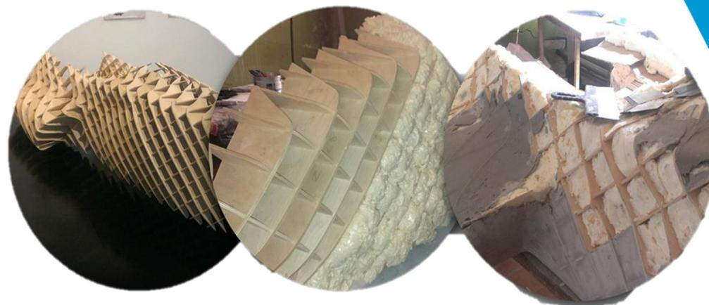
Изготовление "заготовки" корпуса
